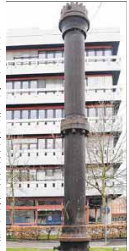
DIESER HOCHDRUCKREAKTOR zur Ammoniak-synthese auf dem Uni-Areal basiert auf Forschungsergebnissen von Fritz Haber. Foto: KIT
